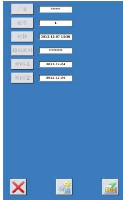
连续输入正确的分期密码后清除当前期的密码，当输入是超级密码时，则全部清除；密码清除后会以红色显示清除的分期日期；如果全部密码清除完毕，则自动退出，返回到信息主界面。
